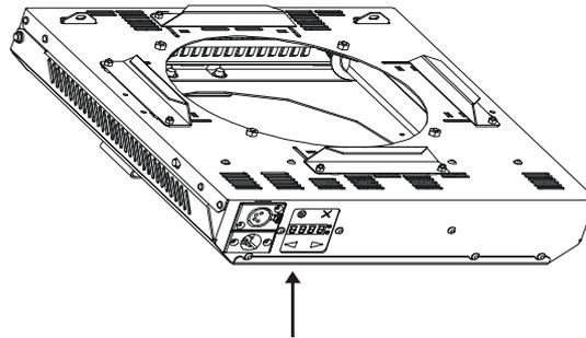
Das Displayfeld besteht aus einer vierstelligen Segmentanzeige, zwei Kontroll-LED's und vier Tasten.
