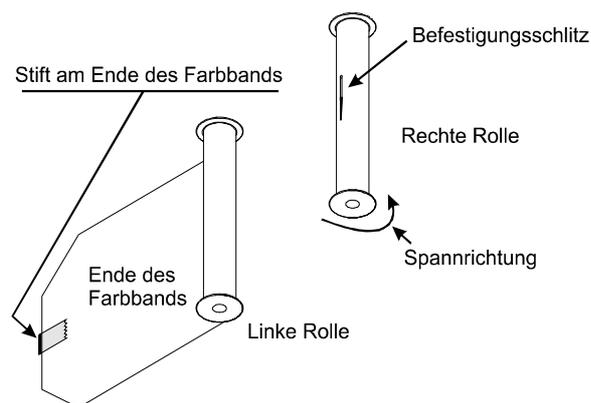
Spannen Sie nun die rechte Rolle, indem Sie diese nach links drehen. Nach der entsprechenden Anzahl an Umdrehungen halten Sie die Rolle, mit dem Befestigungsschlitz nach oben, fest und befestigen Sie das Farbband, indem Sie den Metallstift am Ende des Farbbandes in den Befestigungsschlitz der rechten Rolle schieben.
