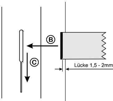
Schieben Sie nun den Metallstift in den Befestigungsschlitz der linken Rolle (B) und zentrieren Sie das Farbband so in der Mitte der Rolle (C), daß die seitlichen Führungen keine Berührung mit dem Farbband haben.
