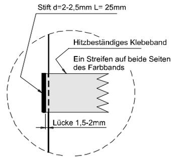
Die Klebebandstreifen zur Verbindung der einzelnen Farben müssen sich auf der lampenabgewandten Seite befinden. Der Wechsler sollte geöffnet (siehe: Wechsler öffnen), mit der Anzeige zugewandt, vor Ihnen liegen. Verbinden Sie den Wechsler mit dem Netzteil und schalten Sie dieses ein.
