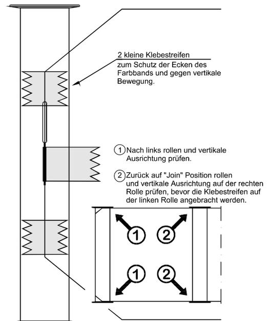
Nun wird das Farbband mittels der Pfeiltasten auf die linke Rolle gewickelt (Schritt 4 und 5).
